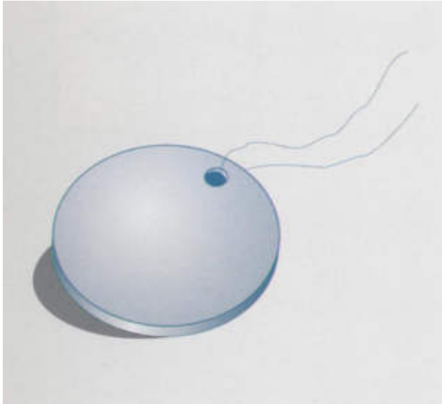
Abb. 1.2.1 Quarzkristallscheibchen mit Zuleitungsdrähtchen
