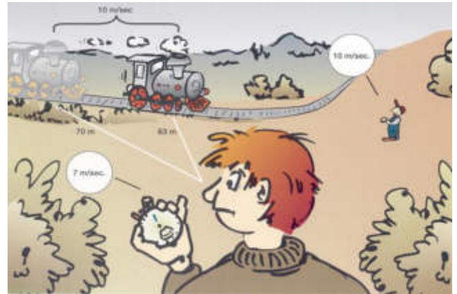
Abb. 1.3.7 Analogie zum Dopplereffekt: Die Höhe der Frequenzverschiebung (hier Näherung der Lokomotive) ist abhängig vom Winkel zwischen Reflektor (Lokomotive) und Sender/Empfänger (Beobachter)
