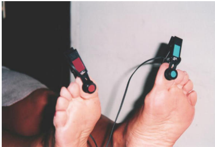
Abb. 1.1.2: Akrale Pulsmessung mit optischen Sensoren
